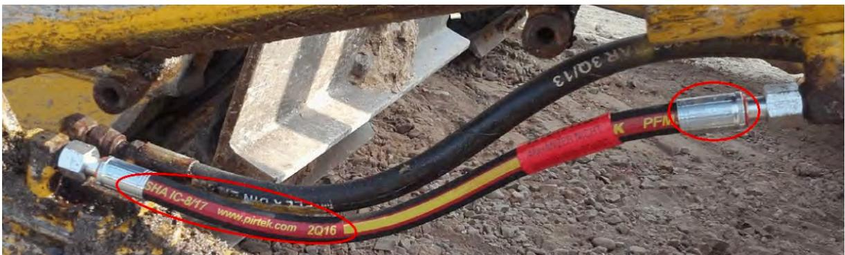
Beispiel 7: Korrekt verlegte Leitung mit Kennzeichnung. Auf der Hydraulikschlauchleitung aufgedruckt (Norm, Schlauchhersteller, Quartal/Jahr) auf der Presshülse eingepreßt (Erzeuger, Datum, max. Druckstufe der Hydraulikleitung) siehe Punkt 4 und 5 im obigen Kapitel
