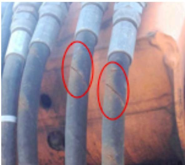
Beispiel 6: Überlackierte Leitungen, dadurch erhöhter Alterungsprozess und Beschädigung.
