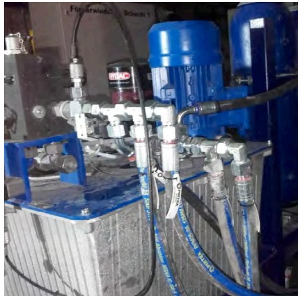
Beispiel 1: Gesamtsystem (Tank, Pumpe, Steuerblock, Hydrospeicher, DBV, Leitungen, Filter)
