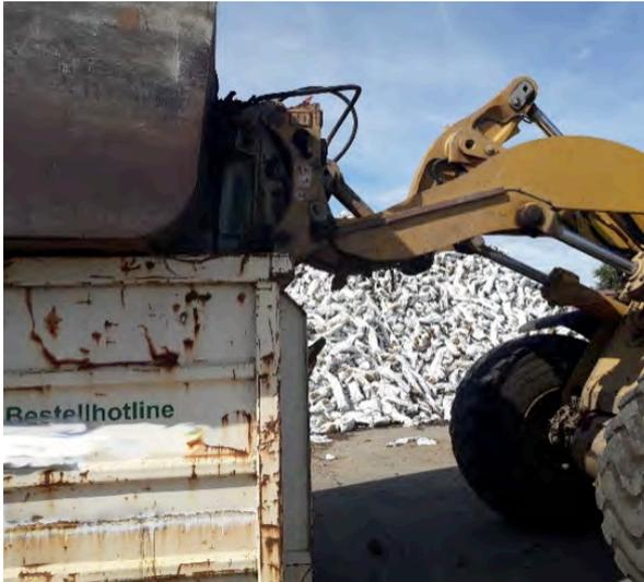
Beispiel 4: Abgestützte Schaufel eines Radladers vor Beginn der Reparatur an den Zylindern
