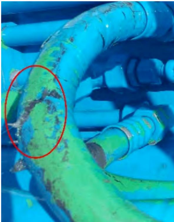
Beispiel 5: sichtbare Beschädigung an Hydraulikleitungen
