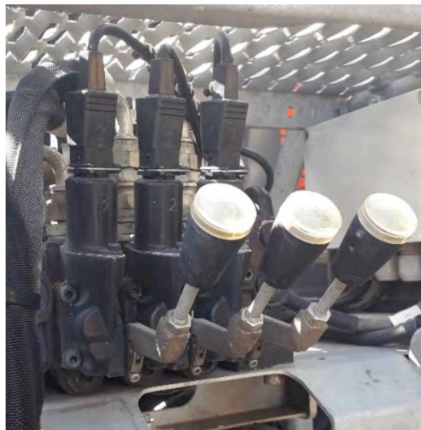
Beispiel 8: Steuerstand. Vorbeilaufende Hydraulikleitungen sind mit einem Berstschutz versehen.
