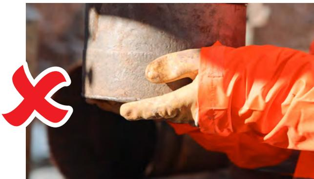
Abb. 7: Untergriff an der Bohrkronen
