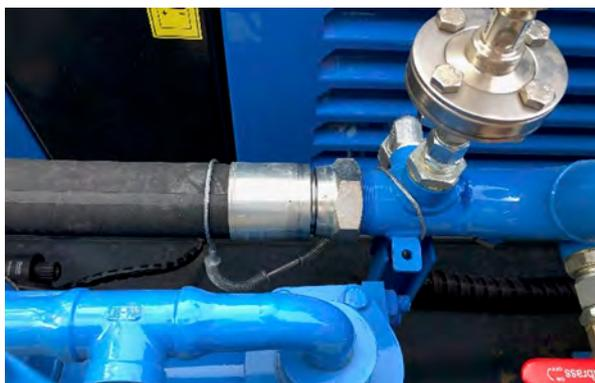
Abb. 4: Fangeinrichtung der Spülleitung
