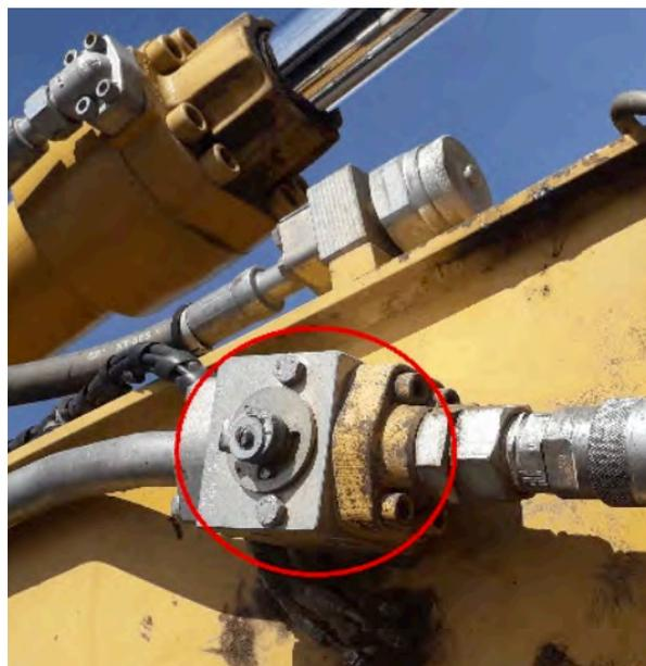
Beispiel 3: Absperrhahn für Anbaugeräte bei einem Bagger
