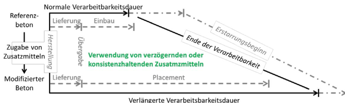
Die empfohlene Konsistenzhaltung kann über die mindestens erforderliche Verarbeitbarkeit zum Ende des gesamten Betoneinbaus festgelegt werden. Für tiefere Elemente sollte, unter Berücksichtigung des Fließmusters und der Rückbaustufen des Kontraktorrohrs, eine detaillierte Beurteilung vorgenommen werden, ob die Mindestverarbeitbarkeit zum Ende der Betonage nicht erforderlich ist.
