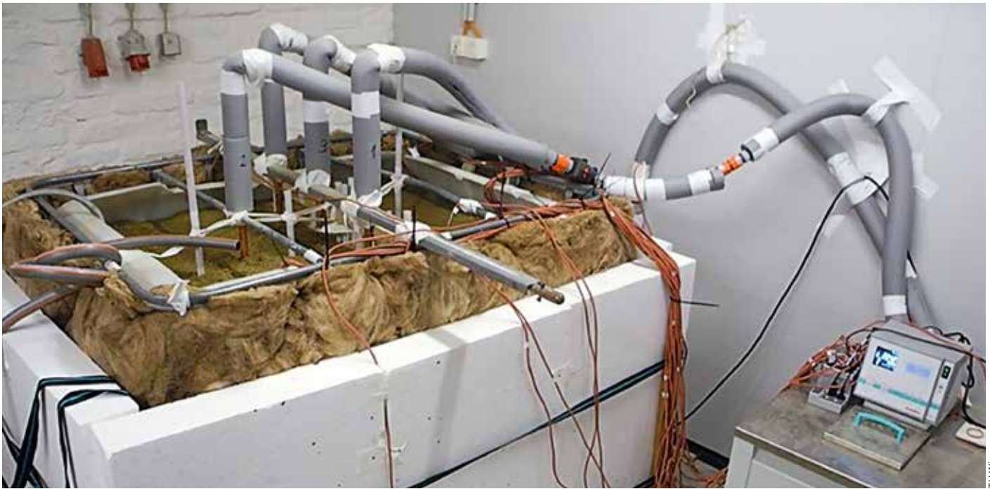
Der Versuchsaufbau des großmaßstäblichen Laborversuchs: vier Gefrierlanzen in einem Versuchbehälter, angeschlossen an einen Tiefkältethermostat, und ein Gerät zur Datenerhebung (Abbildung 4).
