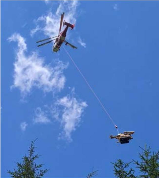
Abbildung 02: Antransport Raupenbohrgerät mittels Helikopters
