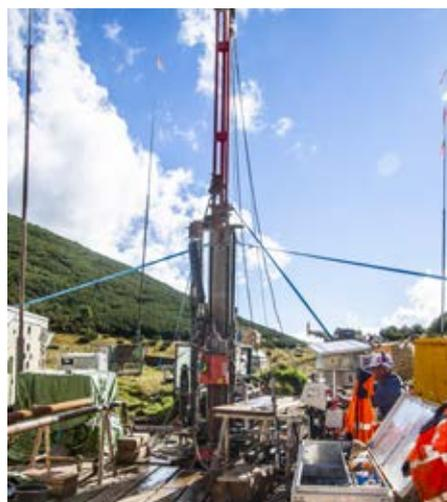
Abbildung 06: Bohrgerät SANDVIK DE142 auf Bohrung 05
