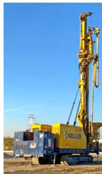
Bild 6 a + b + c Der Sennebogen Seilbagger wurde für diesen Einsatz von der Firma Keller entsprechend modifiziert. Über einen Brunnen wurde der Wasserbedarf gedeckt, im Bild rechts der Baustellentank.
